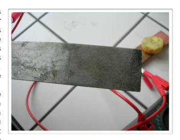
importance. Pour vérifier notre hypothèse nous avons alors mesuré la tension et l'intensité du courant produit en fonction de la surface de contact entre l'électrode et la pomme de terre.
